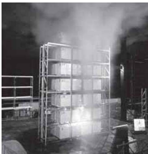
Рис.2 Огневые испытания на объекте
